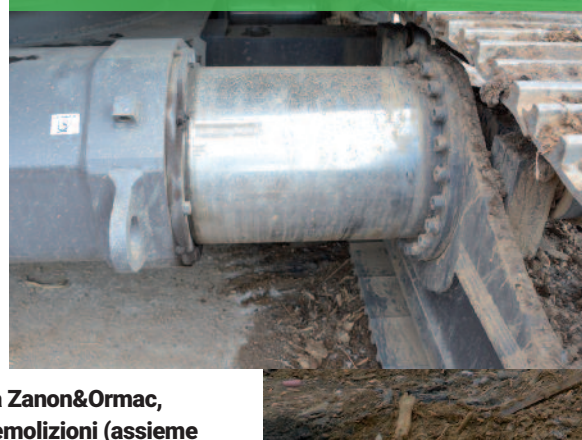
Carro allargabile da 2.990 a 4.000 mm
